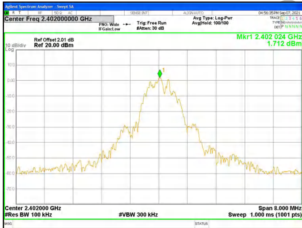
Band Edge NVNT BLE 2402MHz Ant1 Emission
