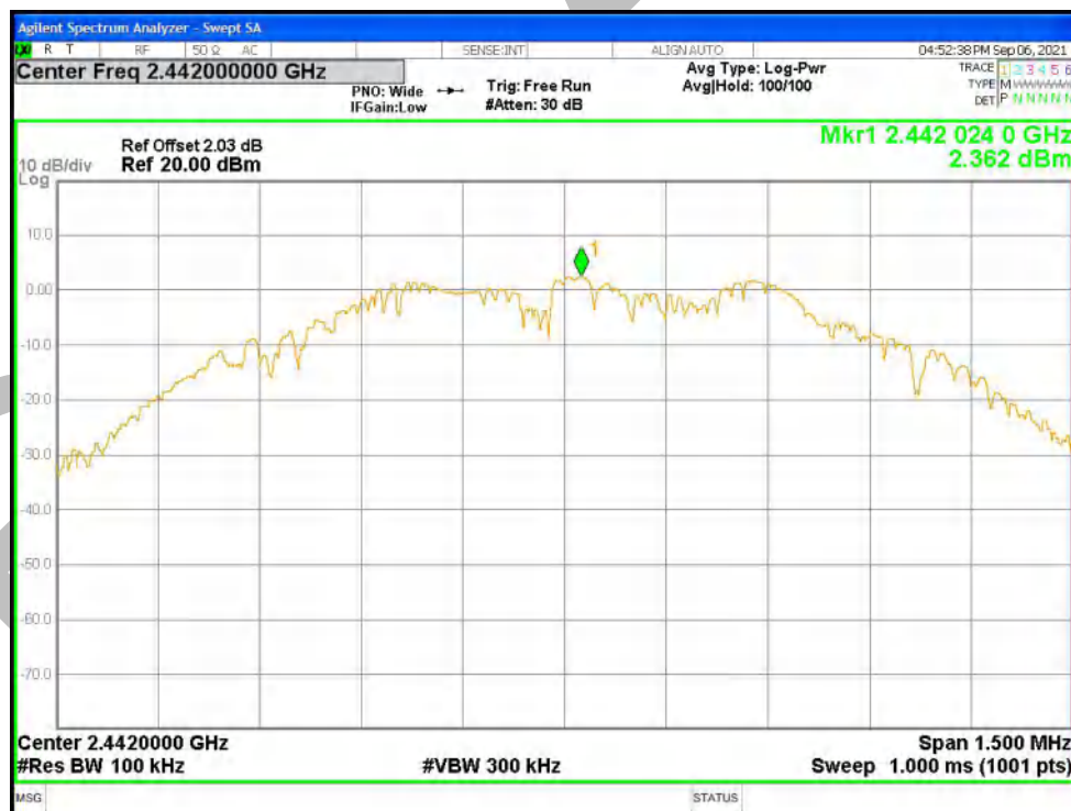
Tx. Spurious NVNT BLE 2442MHz Ant1 Emission
