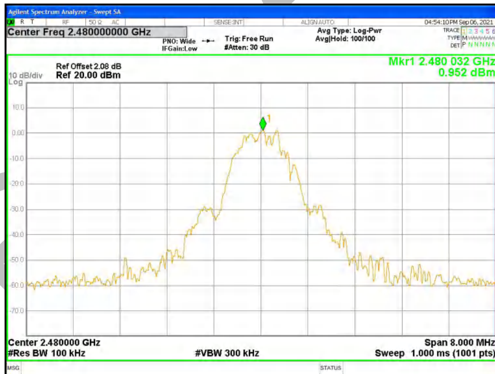
Band Edge NVNT BLE 2480MHz Ant1 Emission
