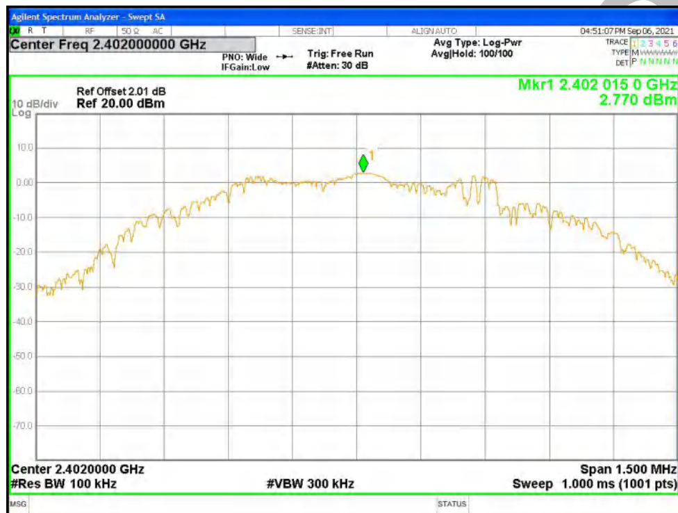
Tx. Spurious NVNT BLE 2402MHz Ant1 Emission
