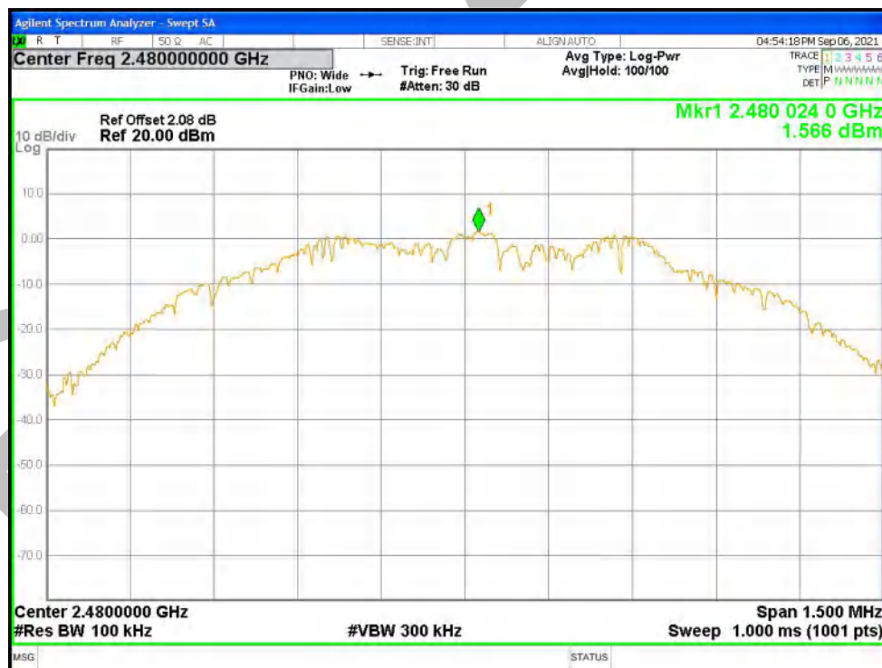
Tx. Spurious NVNT BLE 2480MHz Ant1 Emission
