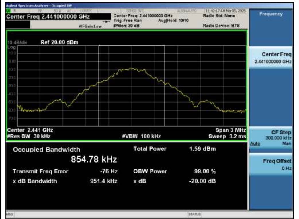
Test_Graph_BR_ANT1_2441_1Mbps_OBW
