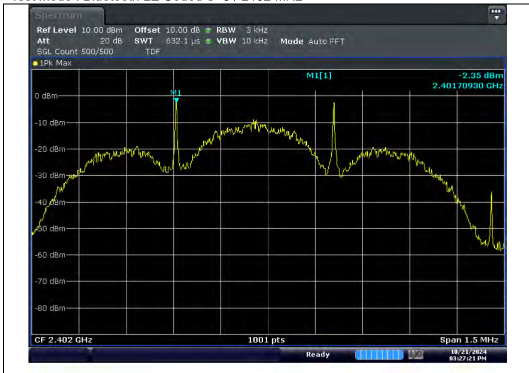
Test Mode : Bluetooth LE Coded S=8 / 2402 MHz
