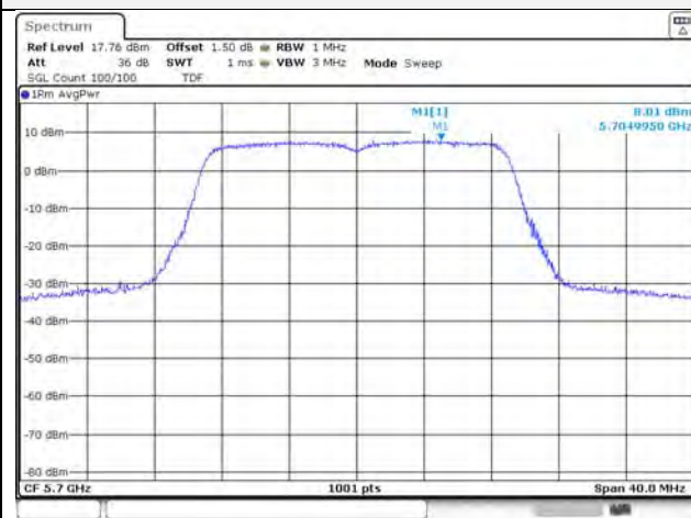
UNII-2C / 802.11ac VHT20 / 5 700 MHz
