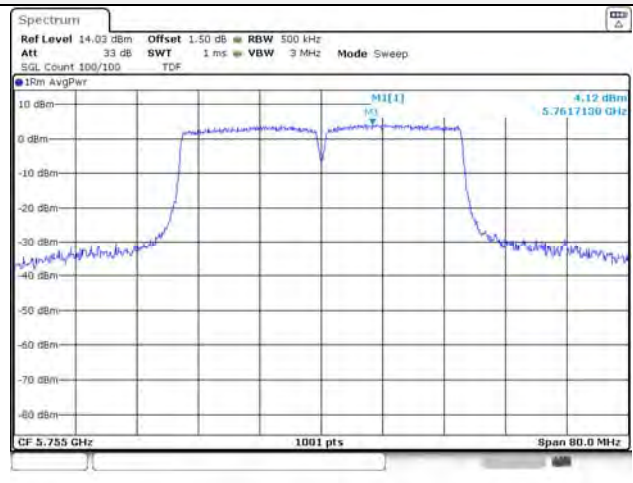
UNII-3 / 802.11ac VHT40 / 5 795 MHz
