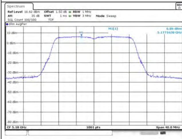
UNII-1 / 802.11ac VHT20 / 5 220 MHz
