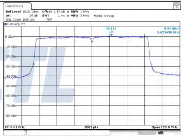
UNII-2C / 802.11ac VHT80 / 5 610 MHz
