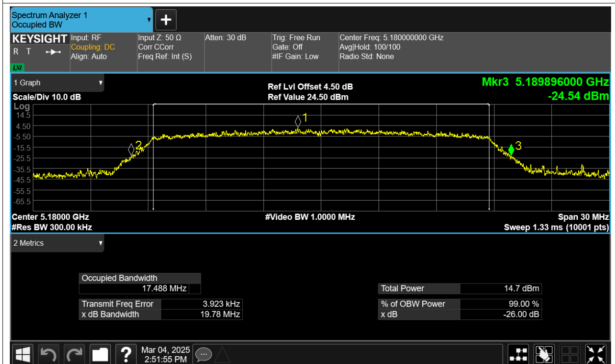
-26dB Bandwidth NVNT ac20 5200MHz Ant1
