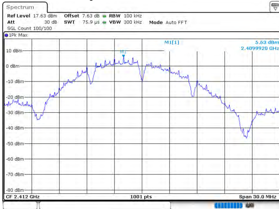
Band Edge NVNT 802.11b 2412MHz Ant1 Ref
