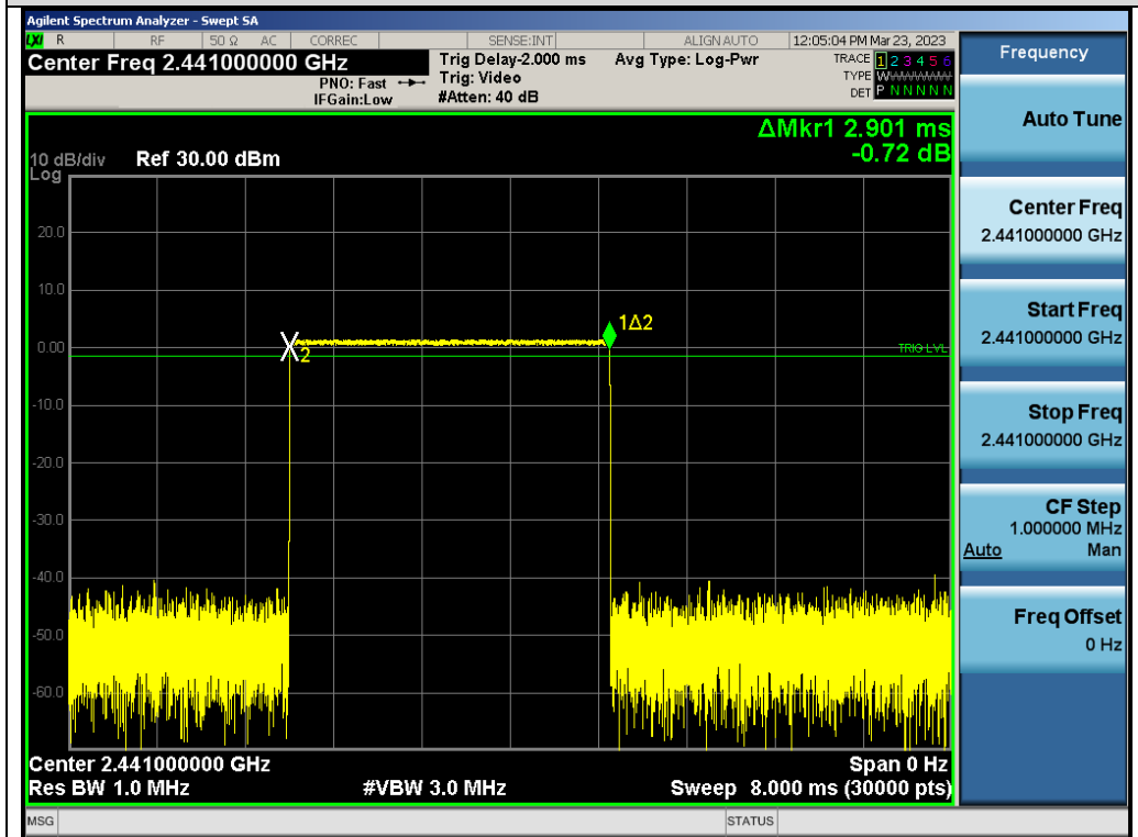
Test_Graph_BR_HOP_ANT1_NA_1Mbps_2441_Time per Burst
