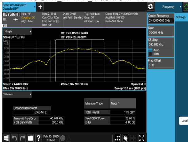
IC OBW BLE 1M HighCH39-2480MHz
