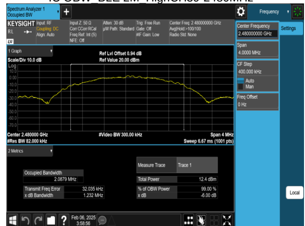
IC OBW BLE 2M HighCH39-2480MHz
