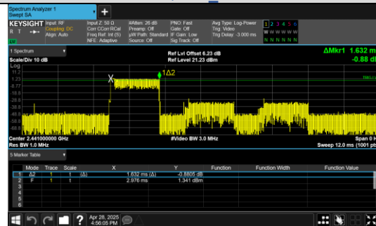
Pulse Width \pi/4 DQPSK 2-DH3
