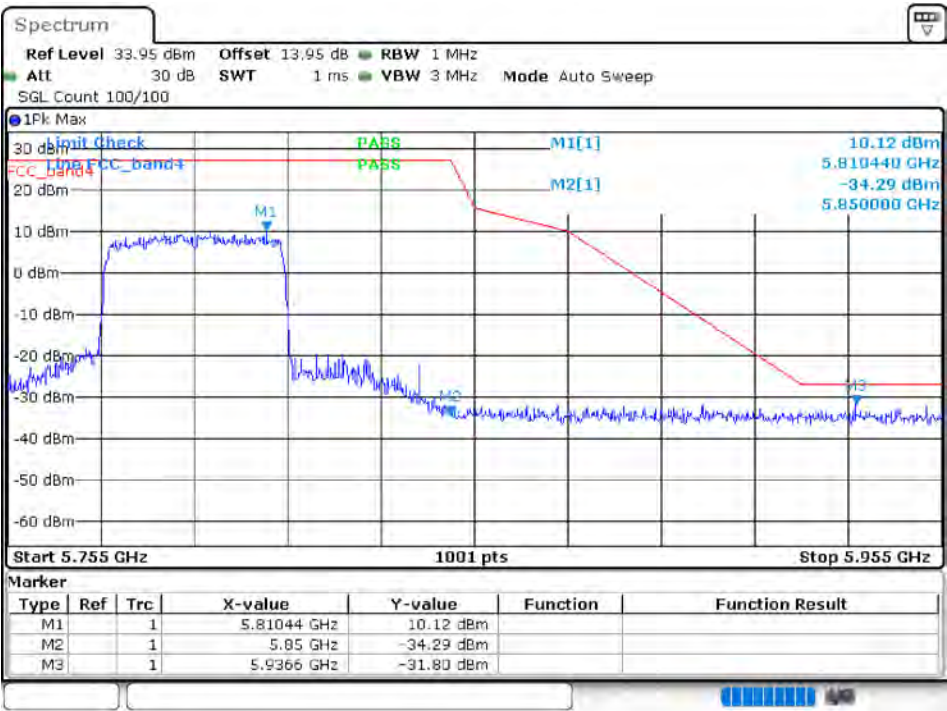
Band Edge NVNT 802.11ax40 5795MHz High Ant 1
