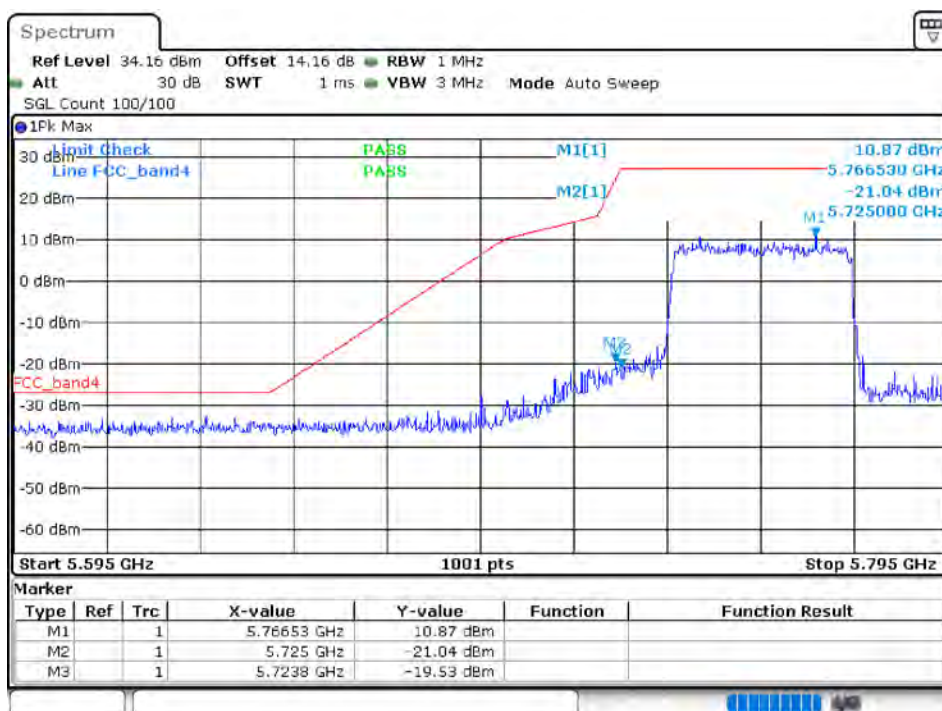
Band Edge NVNT 802.11ax40 5795MHz High Ant 2
