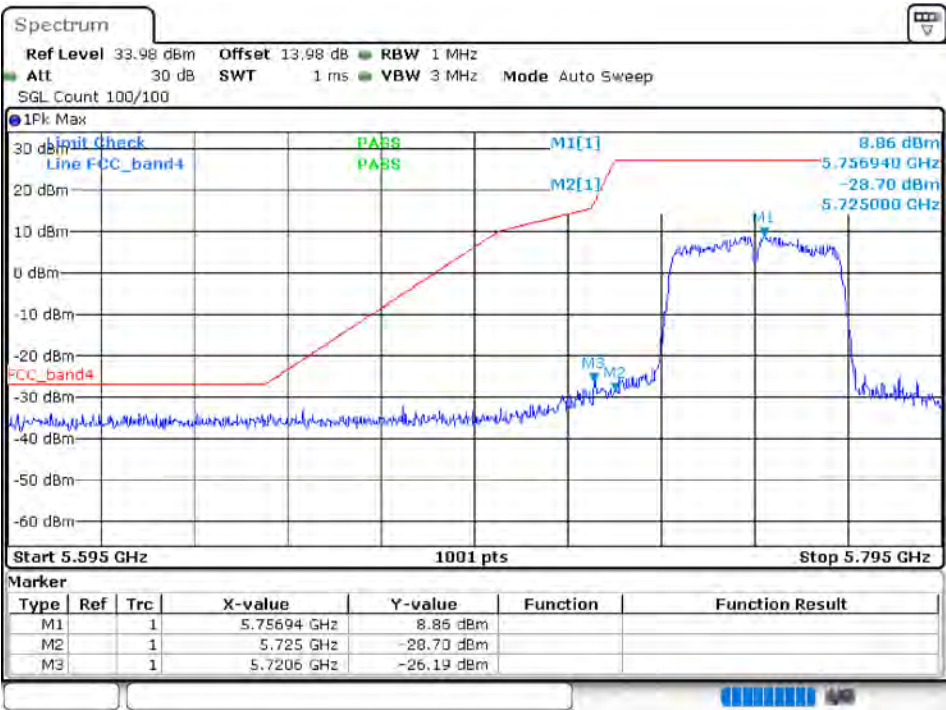
Band Edge NVNT 802.11ac40 5795MHz High Ant 1
