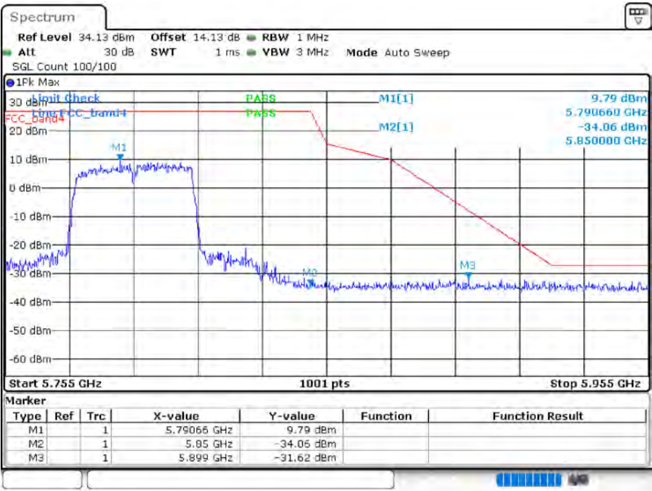
Band Edge NVNT 802.11ac80 5775MHz High Ant 1
