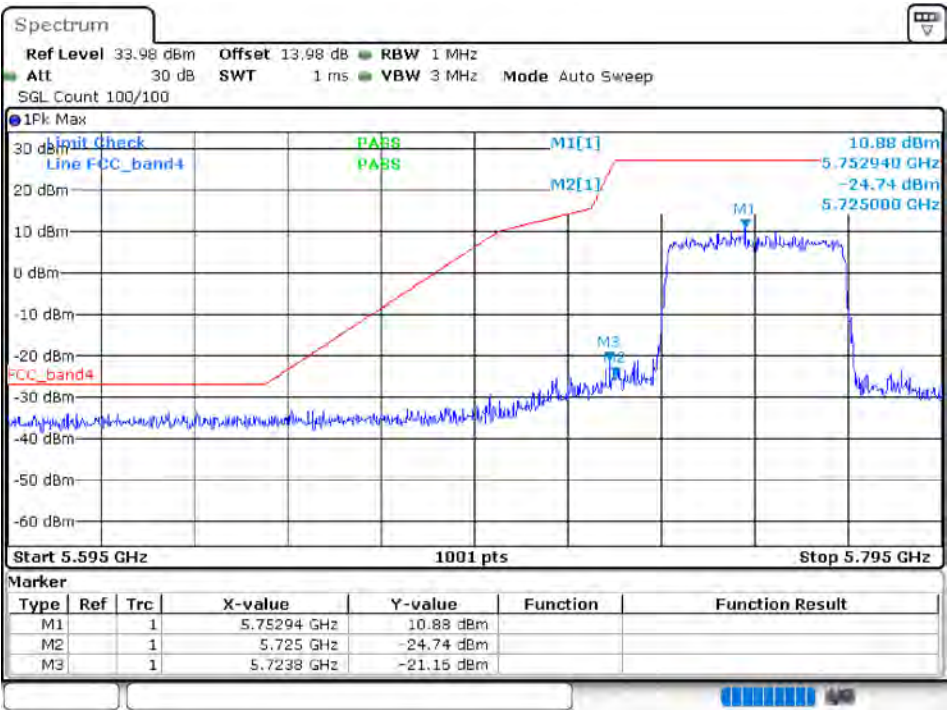
Band Edge NVNT 802.11ax40 5795MHz High Ant 1
