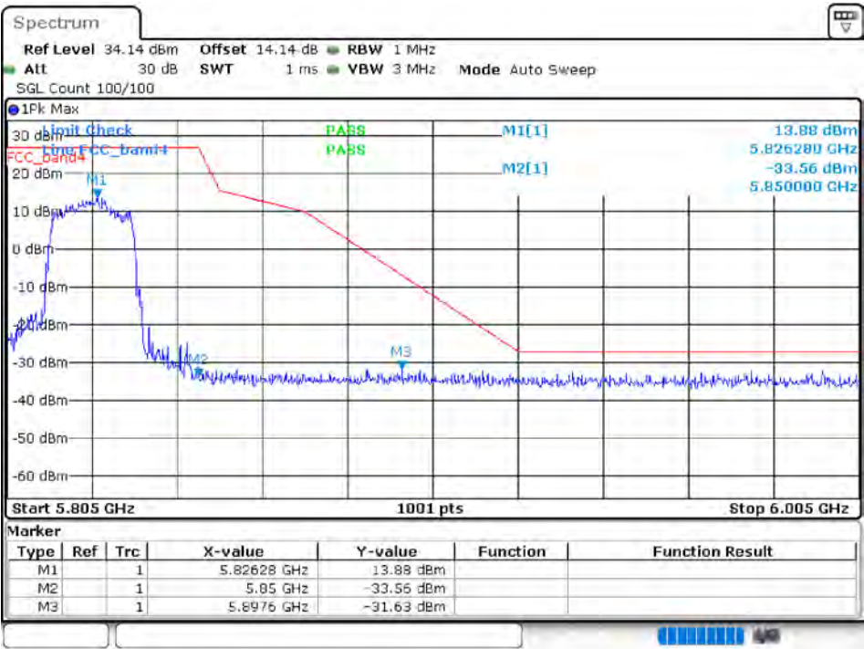
Band Edge NVNT 802.11ax20 5825MHz High Ant 2
