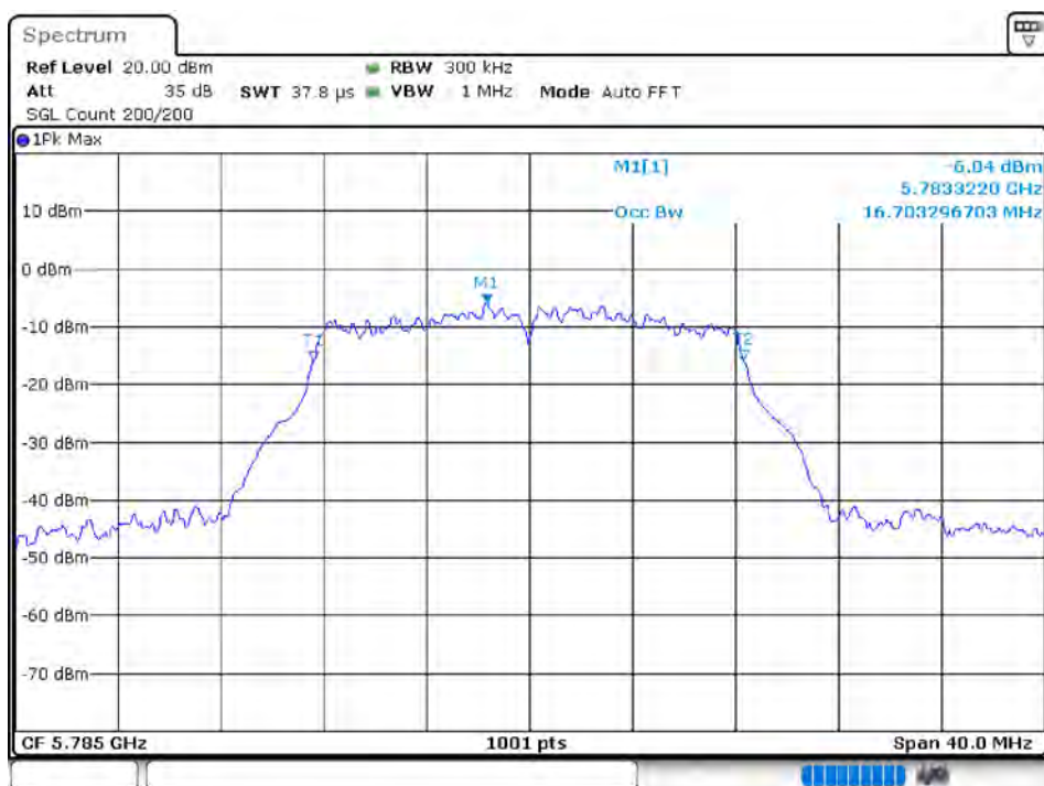
-26 dB BW NVNT 802.11a 5785MHz Ant 1
