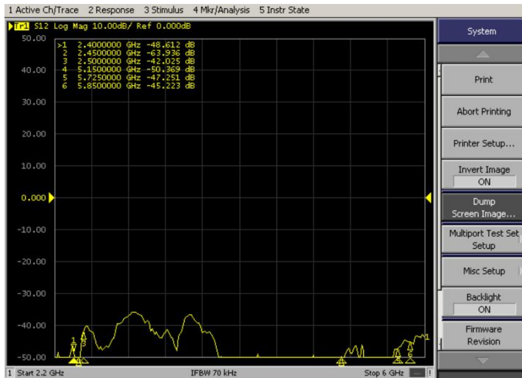
ANT00130-2A-ANT00132-4A 隔离度(isolation )
