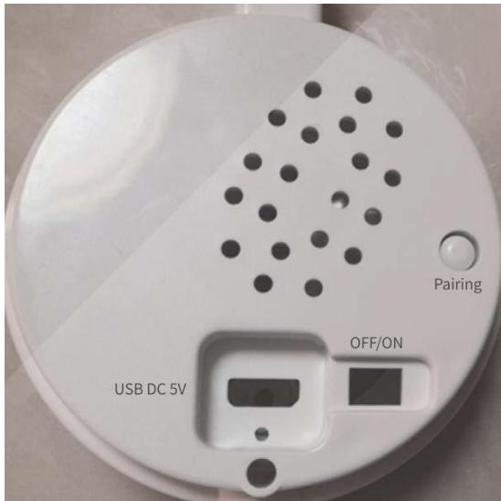
Micro USB DC5V 电源输入 / Micro USB DC5V Power Input
