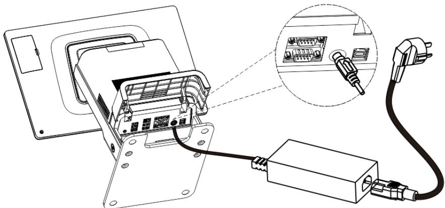
向上翻开藏线盖，露出接口，然后将电源插头插入主板接口,再接上适配器
