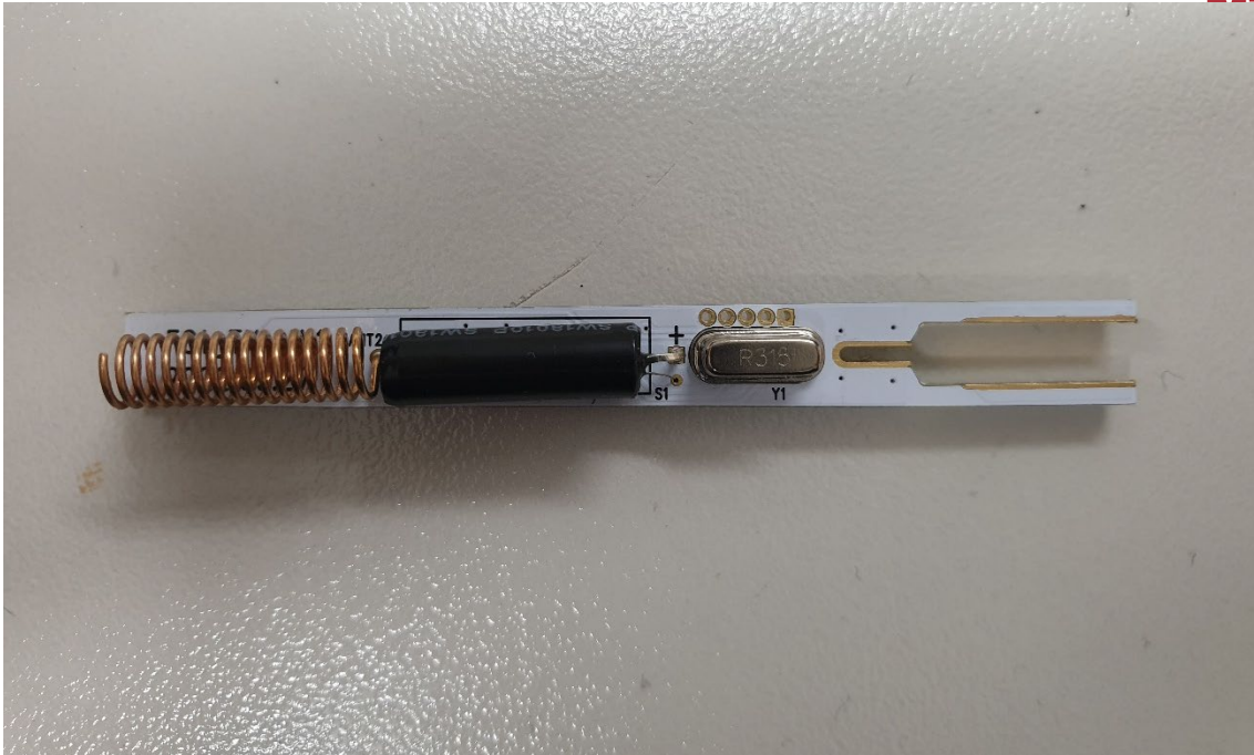
Top of PCB(TX)
