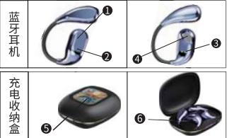
① 功能按键 ② 耳机指示灯 ③ 耳机充电触点
