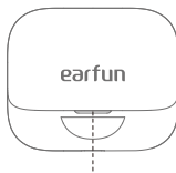
Wskaźnik LED na obudowie ładowania
