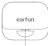
Indicador LED en el estuche de carga
