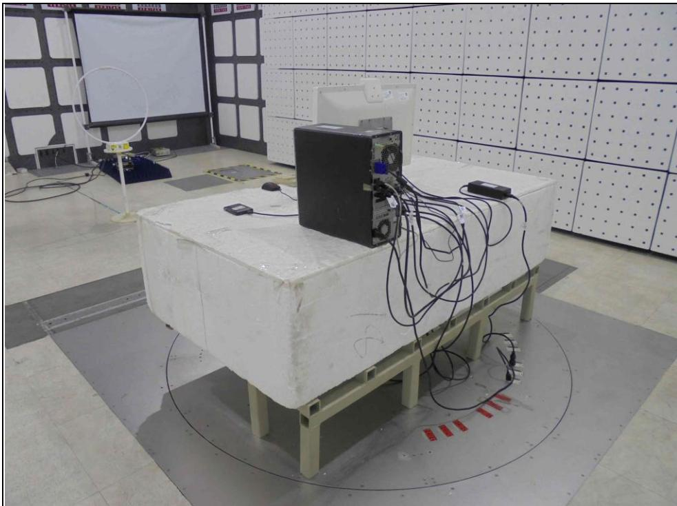
RADIATED EMISSION TEST- Mode B
