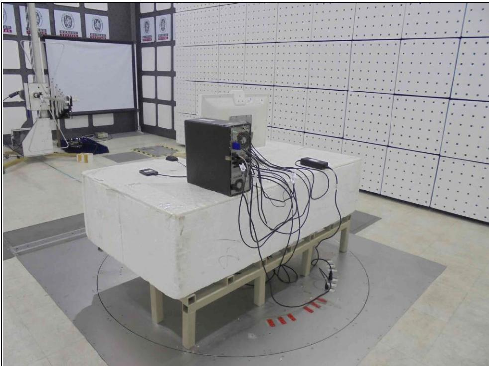
RADIATED EMISSION TEST- Mode B
