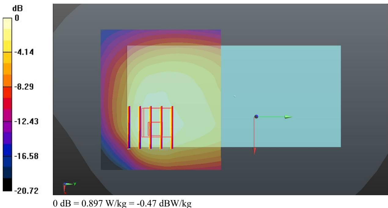
**34\_LTE Band 5\_10M\_QPSK\_1RB\_0Offset\_Back\_10mm\_Ch20525**
