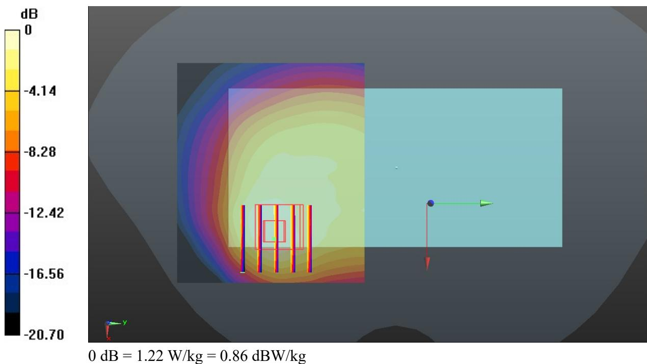
**33\_LTE Band 4\_20M\_QPSK\_1RB\_0Offset\_Back\_10mm\_Ch20175**
