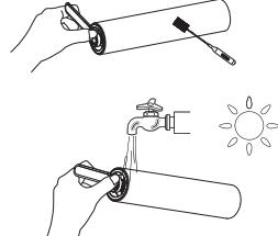
Utilisez l'outil de nettoyage pour retirer les cheveux et les débris enroulés autour du rouleau, puis rincez le rouleau à l'eau et laissez-le sécher complètement avant de le réinstaller.
