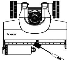
Elimine el pelo y la suciedad de la cámara del cepillo de rodillo y de la abertura con una herramienta de limpieza.
