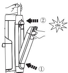
Replacez le réservoir dans l'appareil. Vous entendrez un « clic » lorsque le réservoir est bien en place.
