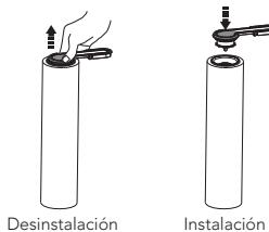
Tire hacia arriba del mango del rodillo para extraerlo. Una vez retirado, instale el mango en el nuevo rodillo de cepillo.
