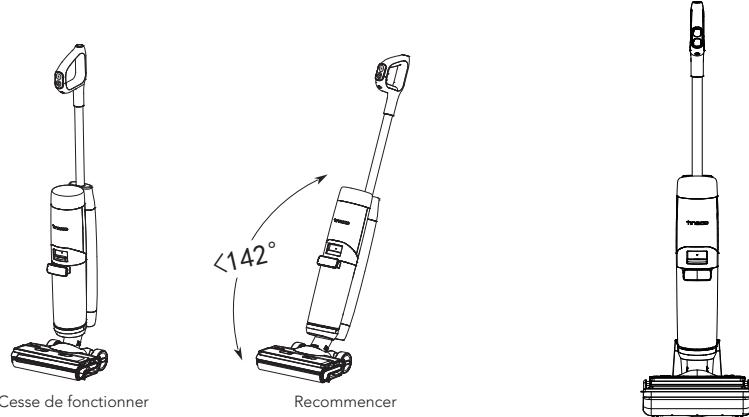
L'appareil s'arrêtera de fonctionner en position verticale et recommencera à fonctionner lorsque vous l'inclinerez.
