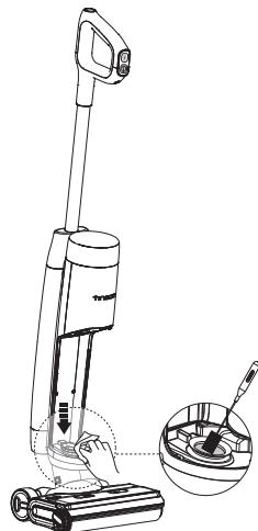
Nettoyez le capteur de poussière avec un chiffon humide ou l'accessoire de nettoyage.
