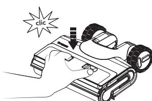
Cuando sustituya la cubierta, fíjela siempre en su posición para evitar fugas.
