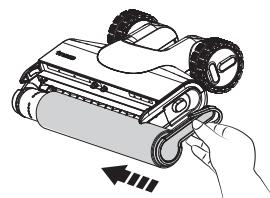
Para volver a colocar el cepillo de rodillo, inserte el extremo izquierdo del asa y, a continuación, acople la pestaña del rodillo a la hebilla magnética del lado derecho para bloquearla.
