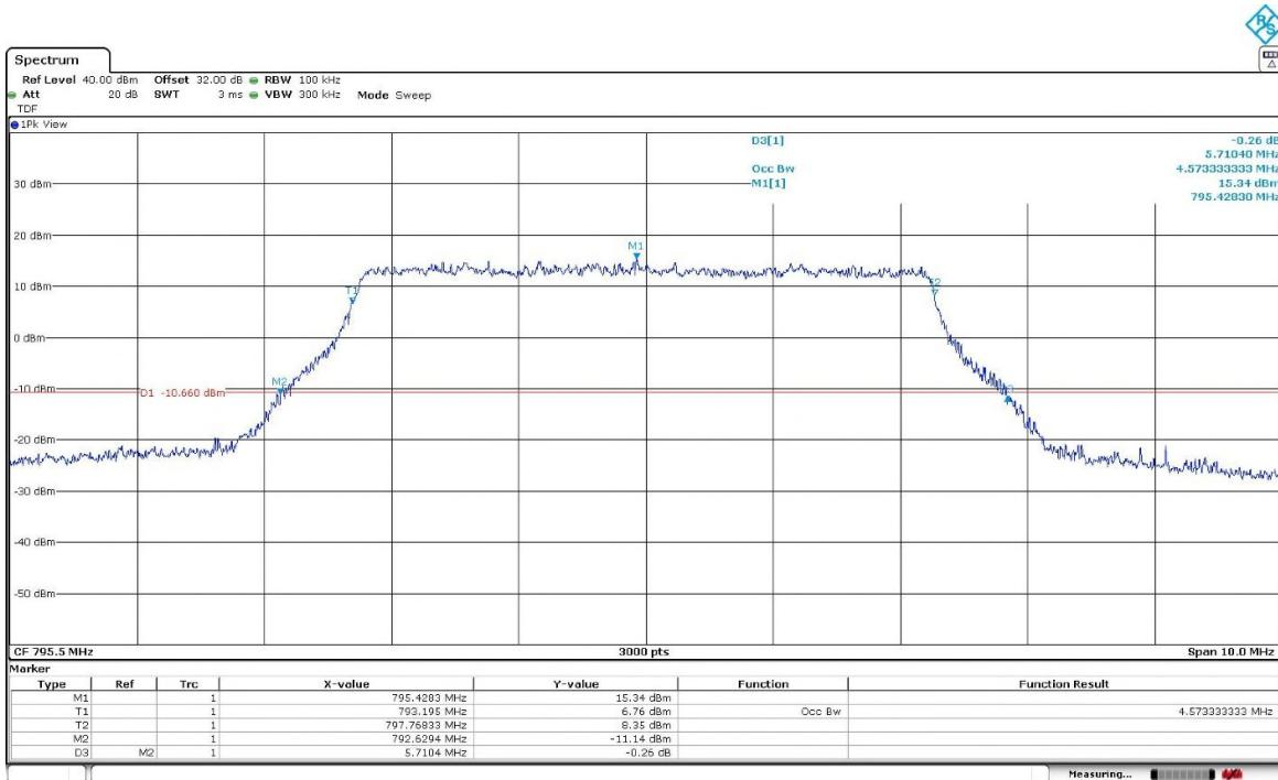
LTE Cat 1bis Band 14. BW=10 MHz. QPSK. RB Size=Max.
