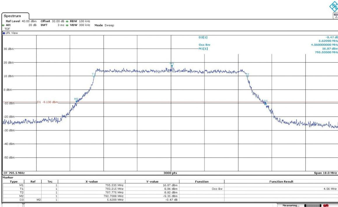
LTE Cat 1bis Band 14. BW = 5 MHz. 16QAM.
