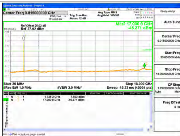
B66 / 20MHz / Mid CH / QPSK
