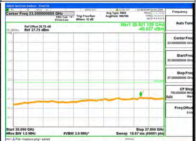
B41-20G-27G / 5MHz / High CH / QPSK
