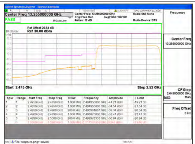
B7 / 20MHz / Low CH / QPSK / FULL RB
