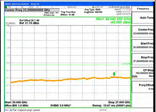
B41-20G-27G / 5MHz / Mid CH / QPSK
