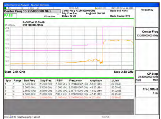
B38 / 10MHz / Low CH / QPSK / FULL RB
