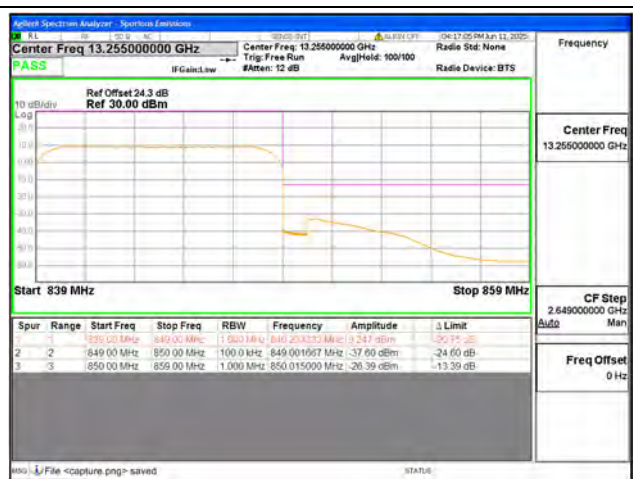
B5 / 10MHz / High CH / QPSK / FULL RB
