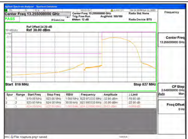
B5 / 1.4MHz / Low CH / QPSK / FULL RB
