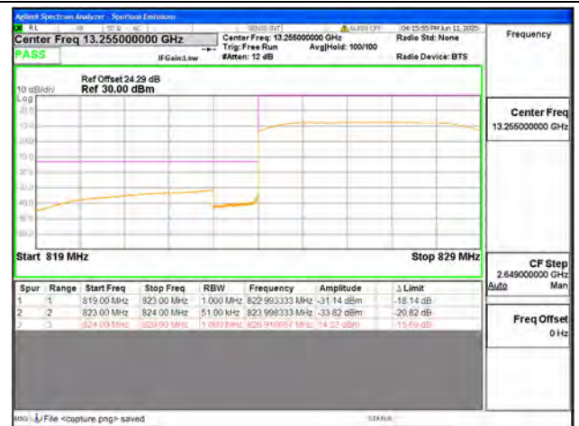
B5 / 5MHz / Low CH / QPSK / FULL RB
