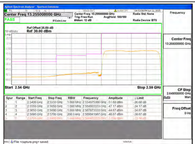
B38 / 20MHz / Low CH / QPSK / FULL RB
