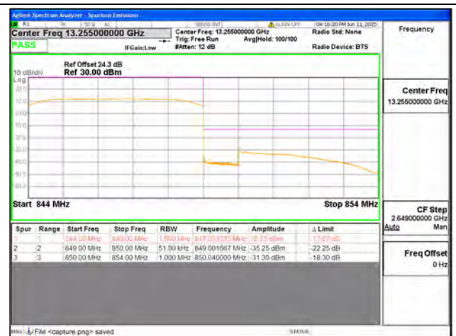
B5 / 5MHz / High CH / QPSK / FULL RB
