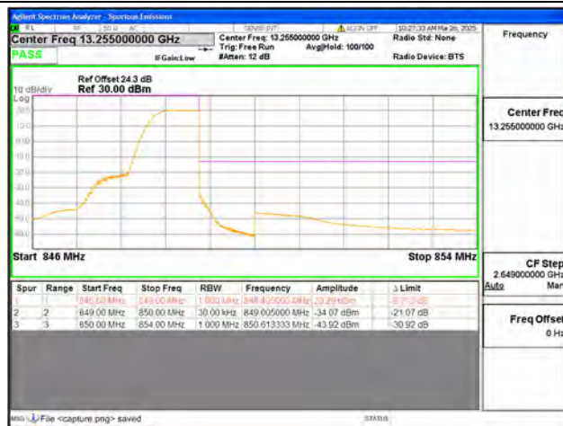
B5 / 1.4MHz / High CH / QPSK / 1 RB
