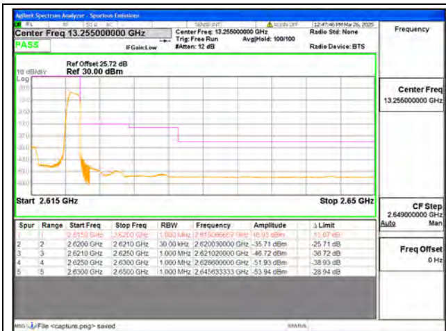
B38 / 10MHz / High CH / QPSK / 1 RB
