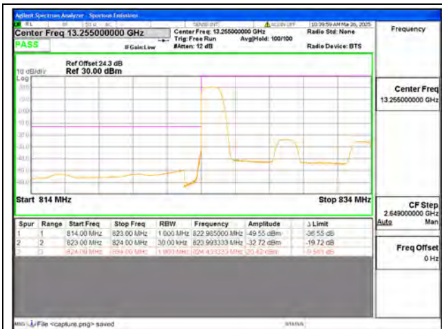
B5 / 10MHz / Low CH / QPSK / 1 RB
