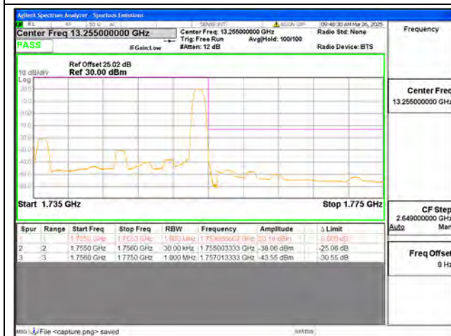
B4 / 20MHz / High CH / QPSK / 1 RB
