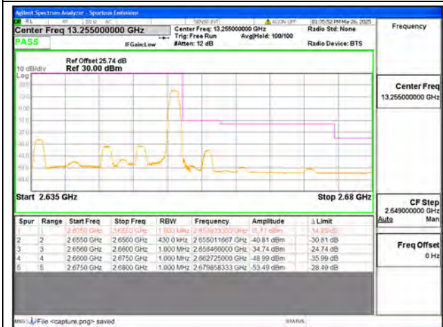
B41 / 20MHz / High CH / QPSK / 1 RB
