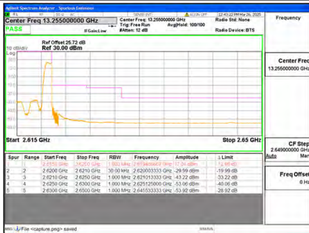
B38 / 5MHz / High CH / QPSK / 1 RB
