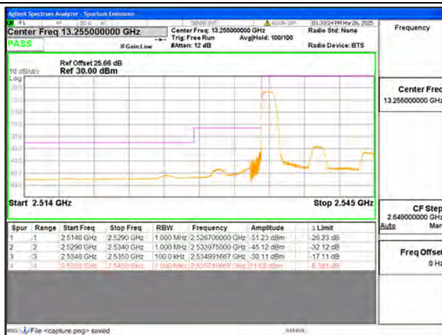
B41 / 10MHz / Low CH / QPSK / 1 RB
