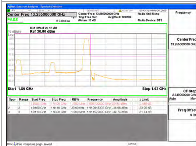
B2 / 20MHz / High CH / QPSK / 1 RB
