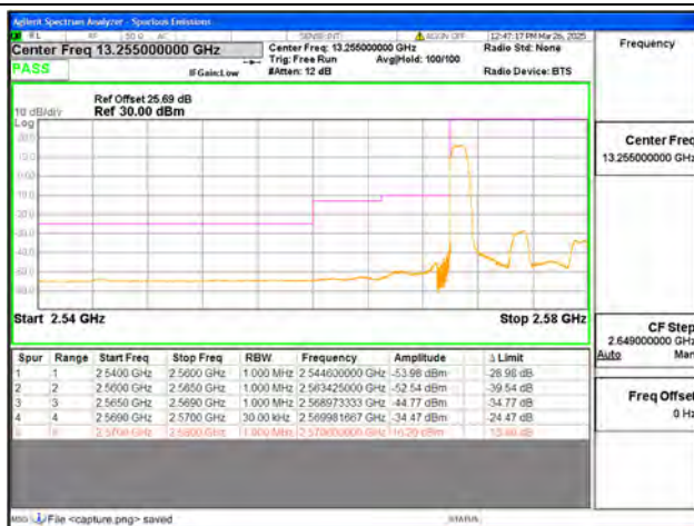
B38 / 10MHz / Low CH / QPSK / 1 RB
