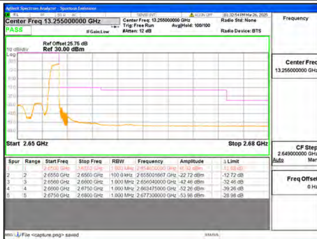
B41 / 5MHz / High CH / QPSK / 1 RB
