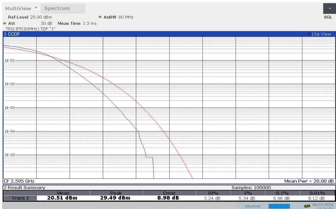
**LTE CA\_38C , 20MHz+20MHz Bandwidth,16QAM**
