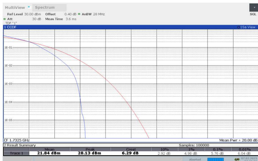
**LTE Band 4 , 20MHz Bandwidth,64QAM**
