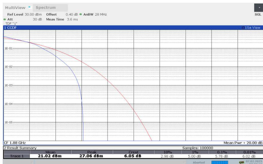
**LTE Band 2 , 10MHz Bandwidth,64QAM**
