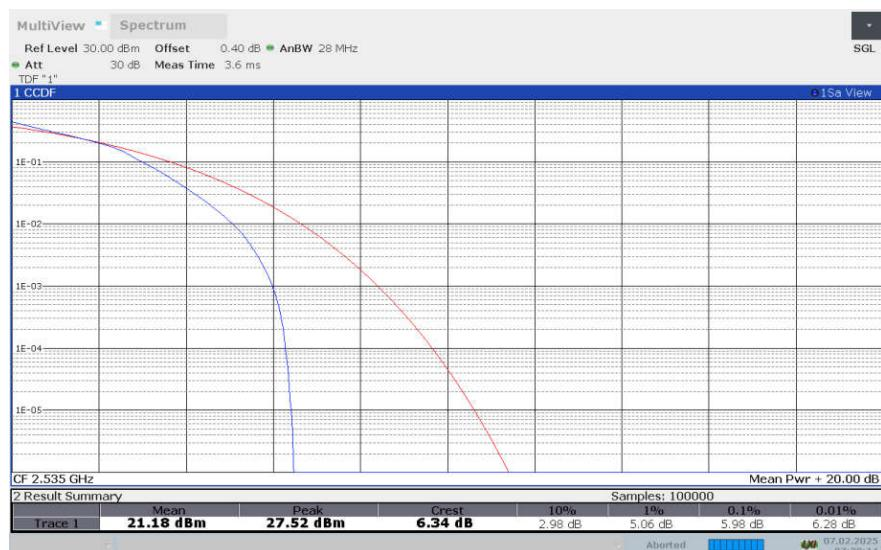
**LTE Band 7, 10MHz Bandwidth, 64QAM**
