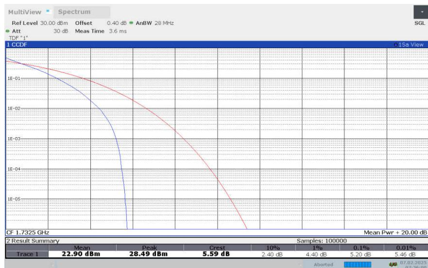
**LTE Band 4 , 20MHz Bandwidth,16QAM**
