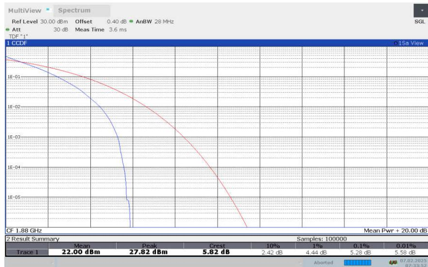
**LTE Band 2 , 20MHz Bandwidth,16QAM**
