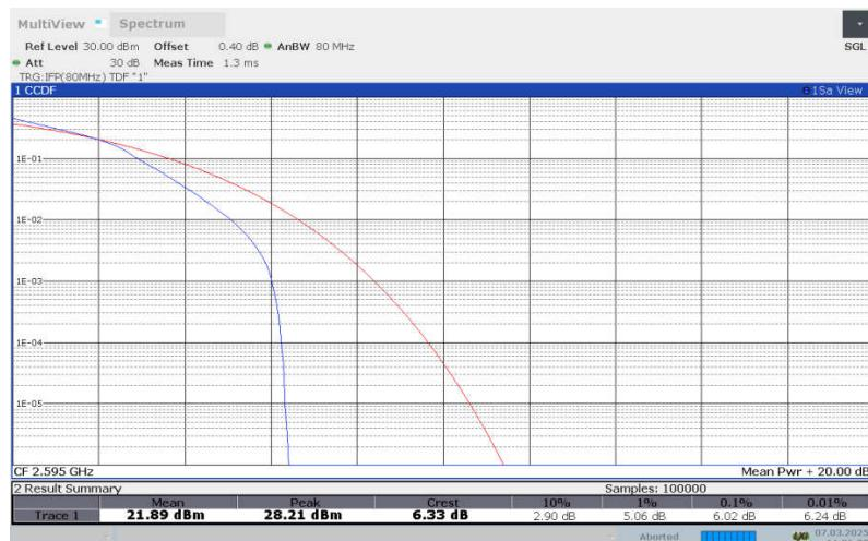
**LTE Band 38 , 20MHz Bandwidth,64QAM**
