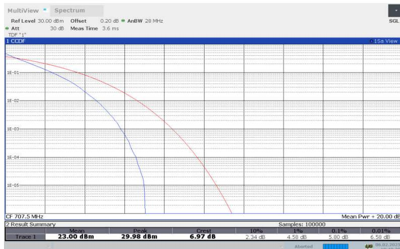
**LTE Band 12 , 10MHz Bandwidth,16QAM**
