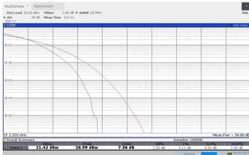
**LTE Band 7, 20MHz Bandwidth, 64QAM**
