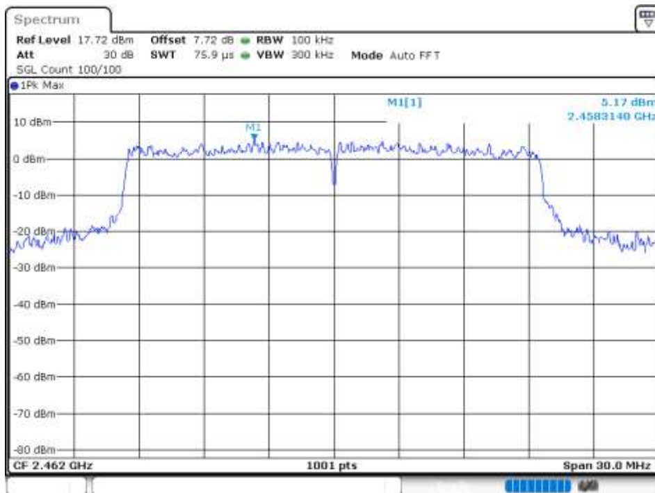
Band Edge NVNT 802.11ax20 2462MHz Ant 0 Ref
