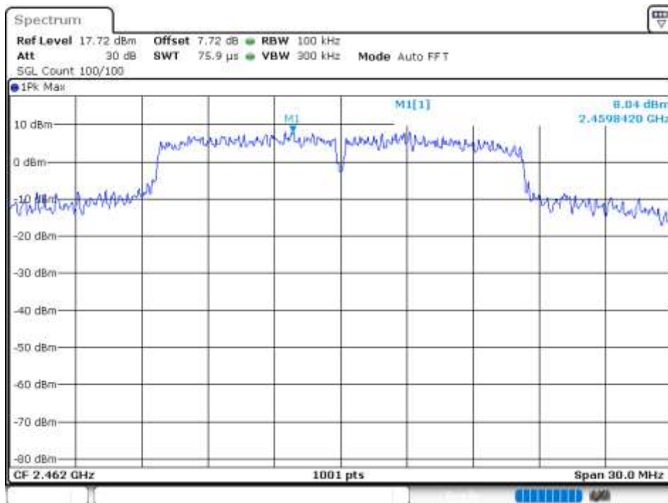
Band Edge NVNT 802.11g 2462MHz Ant 0 Ref
