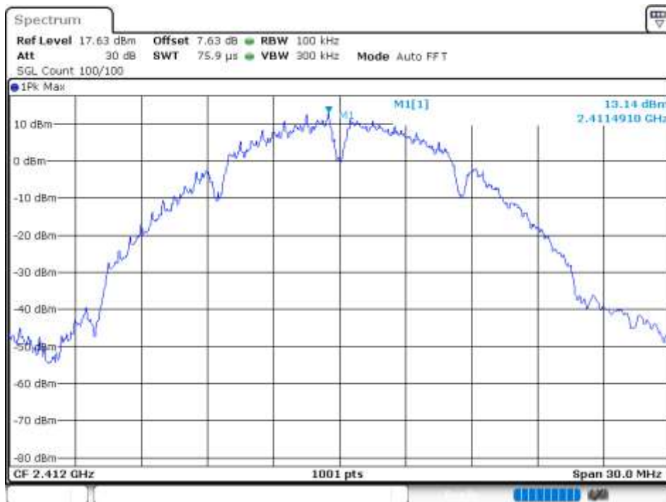
Band Edge NVNT 802.11b 2412MHz Ant 0 Ref
