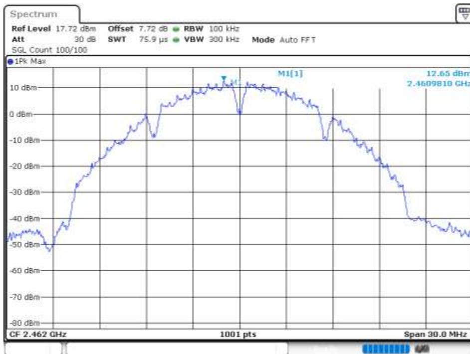
Band Edge NVNT 802.11b 2462MHz Ant 3 Ref
