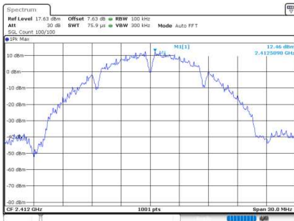
Band Edge NVNT 802.11b 2412MHz Ant 1 Ref
