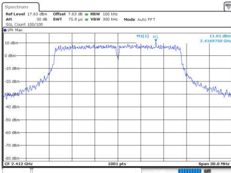
Band Edge NVNT 802.11g 2412MHz Ant 3 Ref
