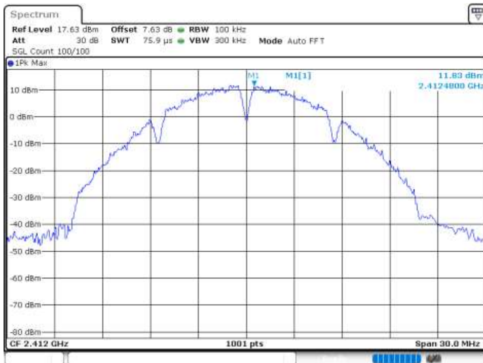
Band Edge NVNT 802.11b 2412MHz Ant 2 Ref
