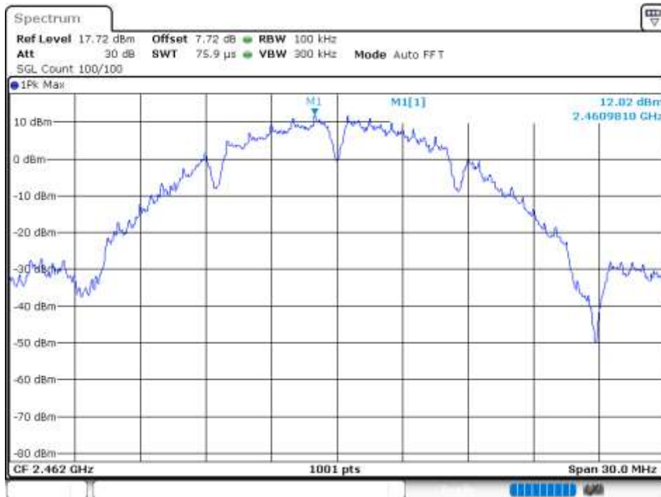
Band Edge NVNT 802.11b 2462MHz Ant 0 Ref
