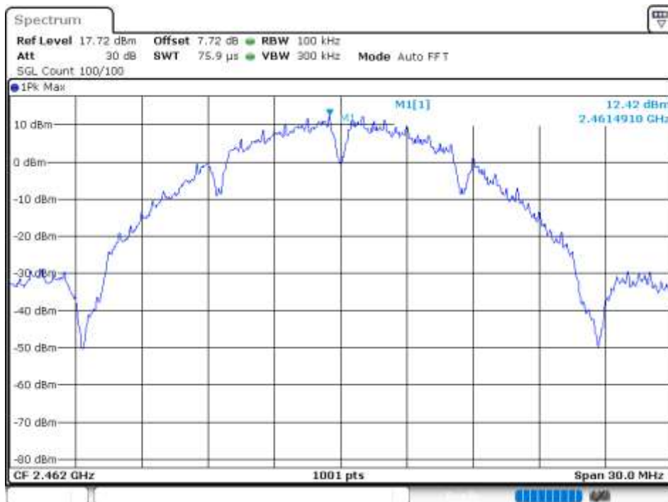
Band Edge NVNT 802.11b 2462MHz Ant 1 Ref
