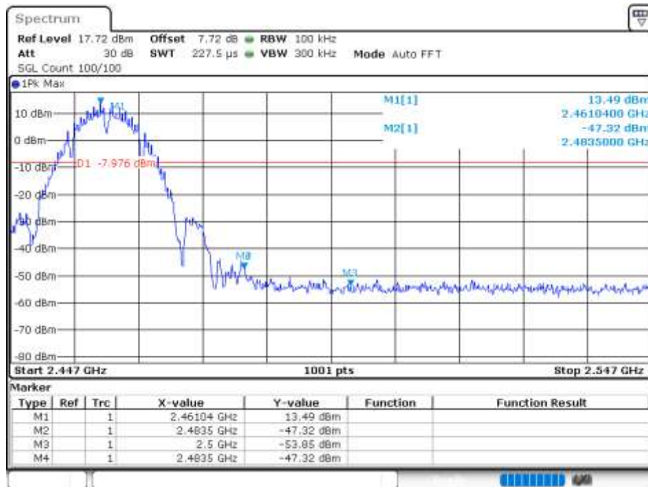
Band Edge NVNT 802.11b 2412MHz Ant 1 Ref
