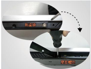
1、首先用钥匙打开防盗锁，然后将壁挂螺丝拧出
