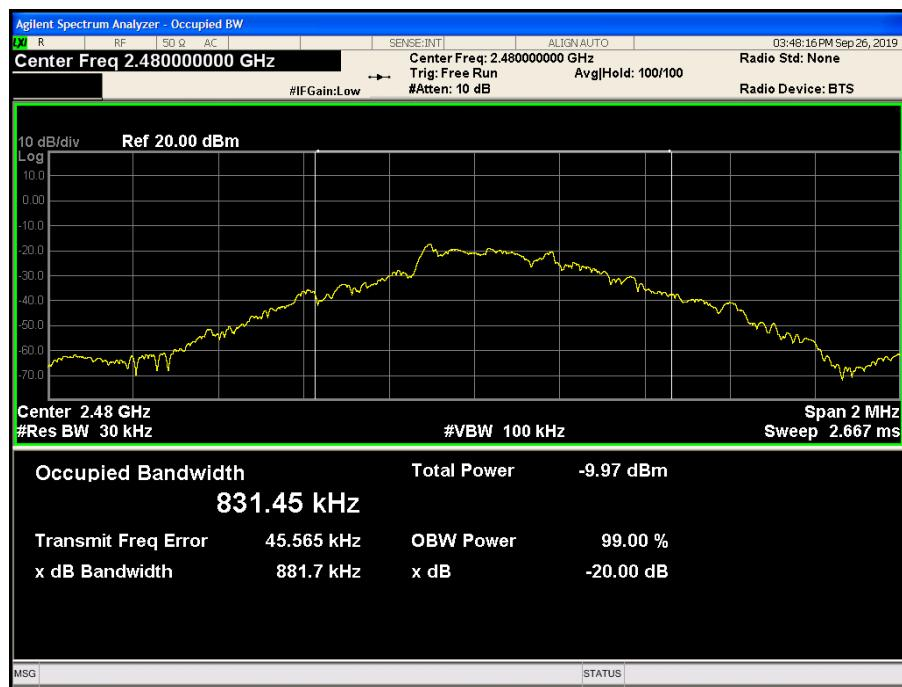
Test Mode:  $\pi/4$ DQPSK
