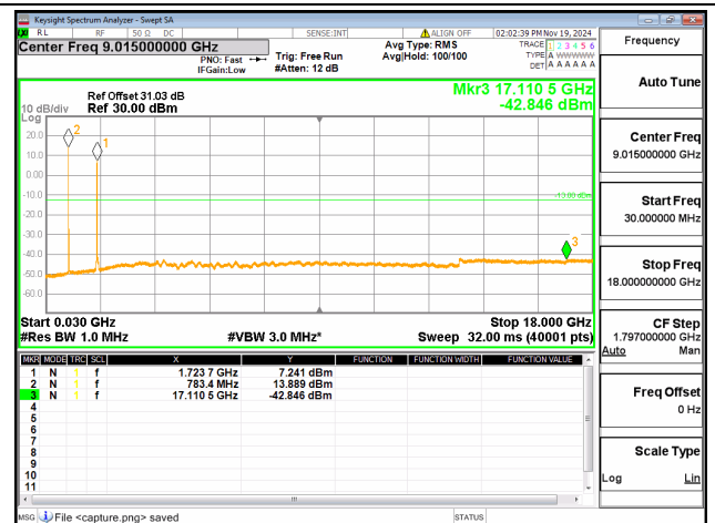
13A-66A / 10+20MHz / QPSK / Low+Low CH / 50@0-100@0
