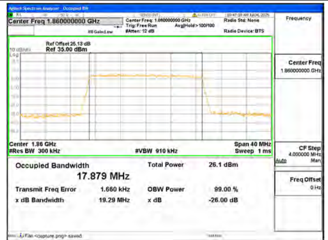
B2 / 20MHz / QPSK/ Low CH
