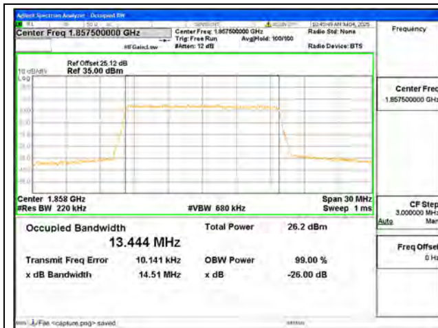
B2 / 15MHz / QPSK/ Low CH
