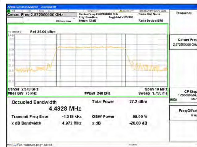
B38 / 5MHz / QPSK/ Low CH
