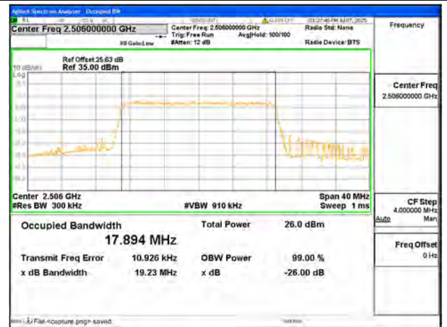
B41 / 20MHz / QPSK/ Low CH
