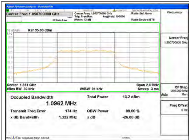
B2 / 1.4MHz / QPSK / Low CH
