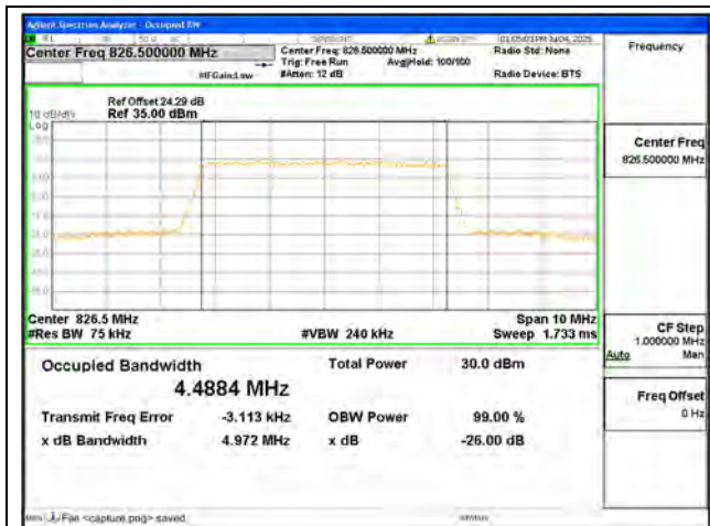
B5 / 5MHz / QPSK/ Low CH
