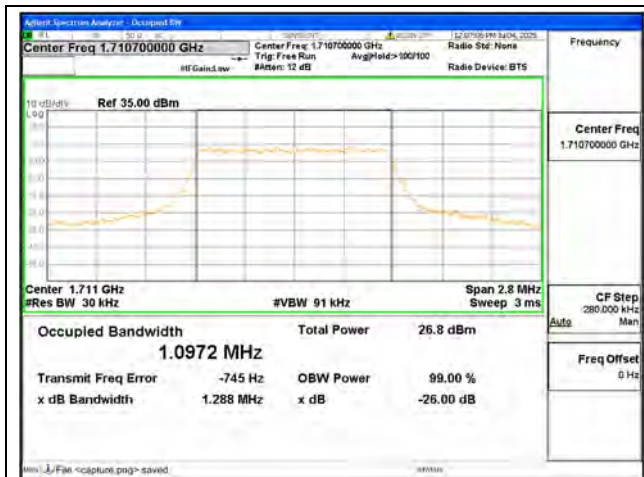
B4 / 1.4MHz / QPSK/ Low CH
