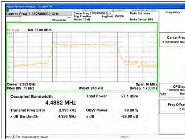
B40-2 / 5MHz / QPSK/ Low CH
