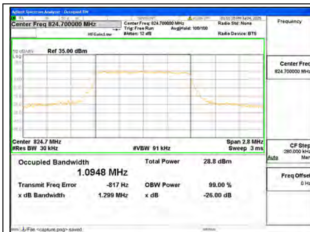
B5 / 1.4MHz / QPSK/ Low CH
