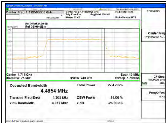
B4 / 5MHz / QPSK/ Low CH
