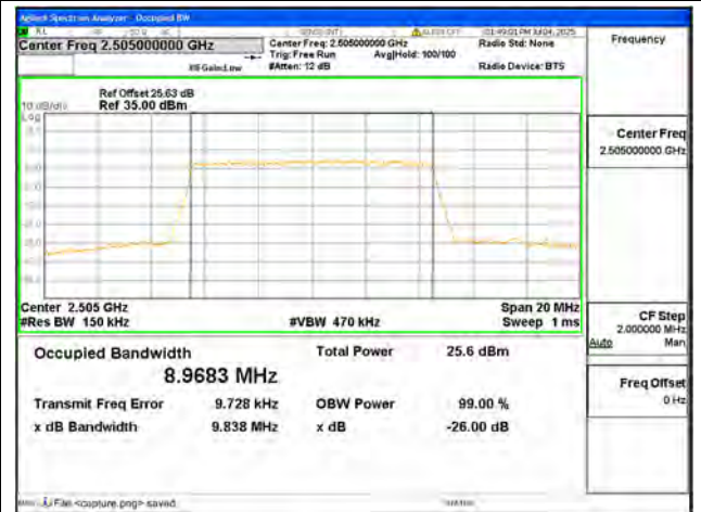
B7 / 10MHz / QPSK/ Low CH
