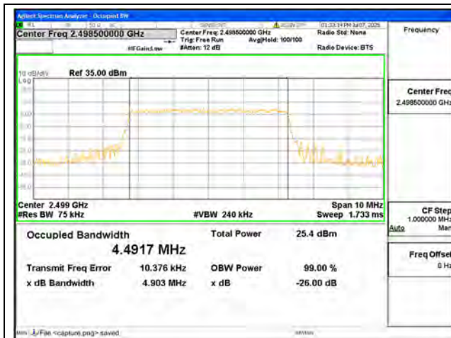
B41 / 5MHz / QPSK/ Low CH
