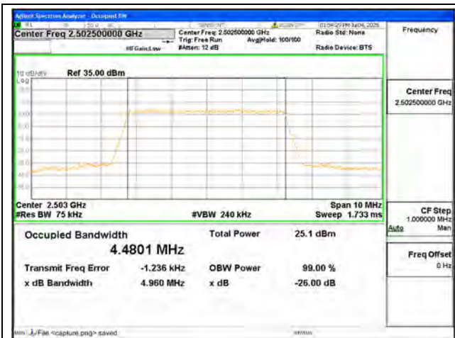
B7 / 5MHz / QPSK/ Low CH
