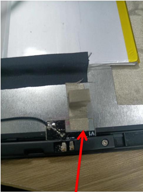
4G 主天线小板贴导电布和导电泡棉与屏和金属后盖接地
