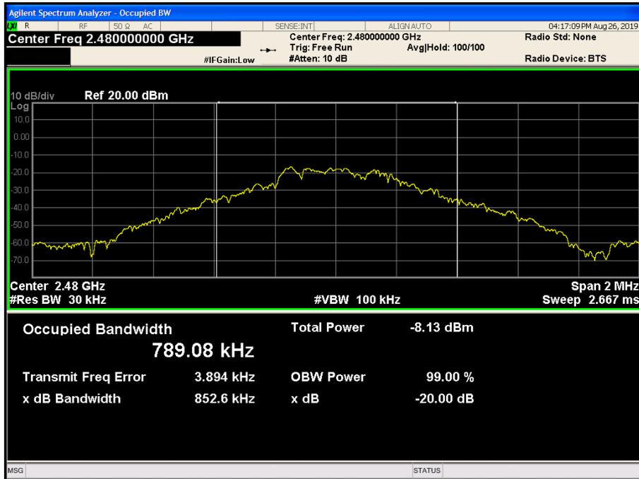
Test Mode:  $\pi$ /4DQPSK
