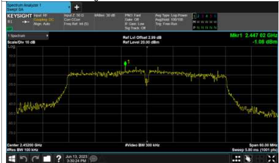
Band Edge NVNT n40 2452MHz Ant1 Ref
