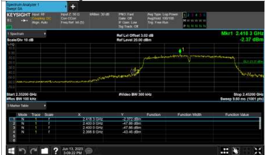
Band Edge NVNT n40 2452MHz Ant1 Ref
