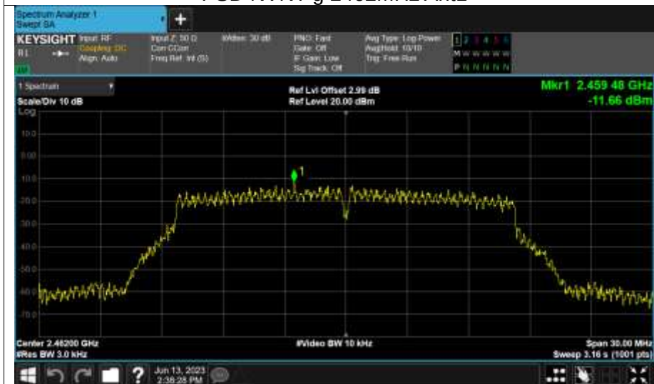
PSD NVNT g 2462MHz Ant1
