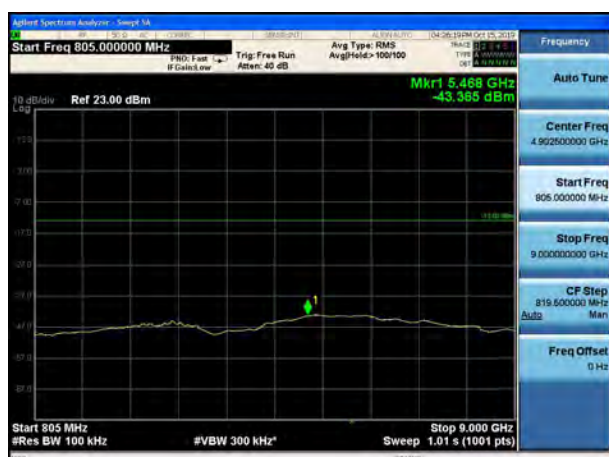
LTE Band 14 QPSK 10MHz 1 RB CH- High (805MHz~ 9GHz)
