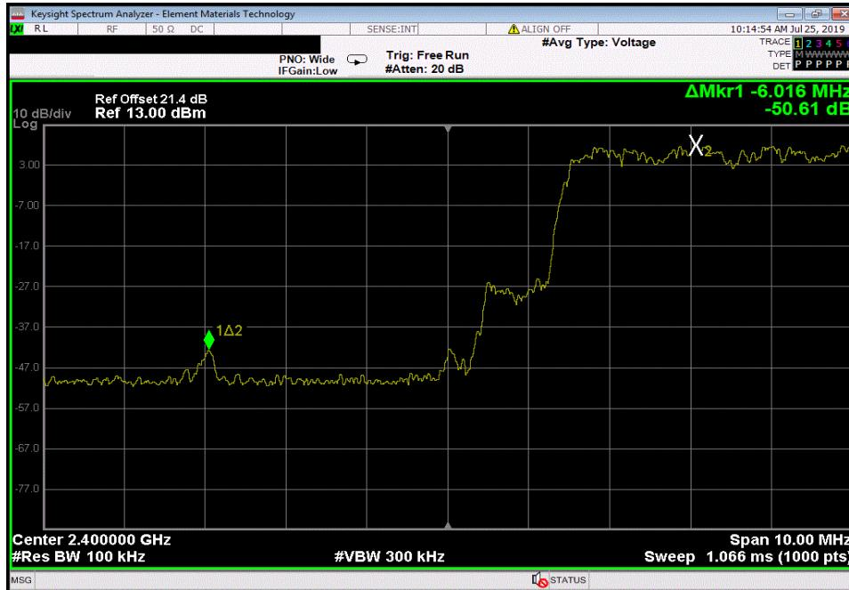
2DH5, pi/4-DQPSK, Hopping Mode, High Channel, 2480 MHz
