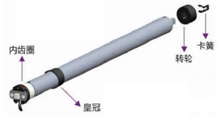
内齿圈: inner gear ring
