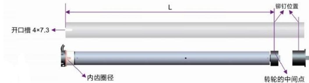
开口槽 Open slot    内齿圈径 Inner gear ring diameter    铆钉位置 Rivet position
