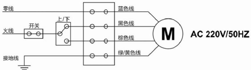
零线 null line      火线 firewire      接地线 ground wire      开关 switch
