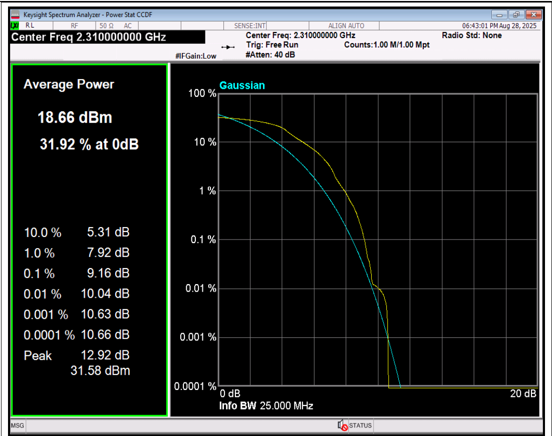
Band40(2305-2315) QPSK BW=10MHz Channel=38750 RB Size=1 Position=#0
