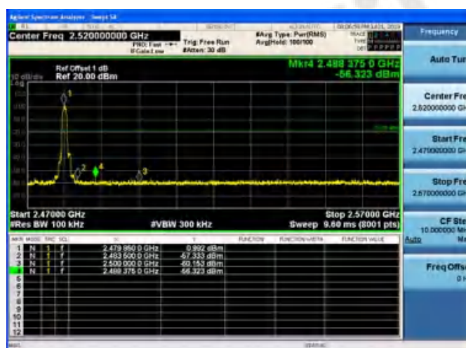
Right Band edge hopping off
