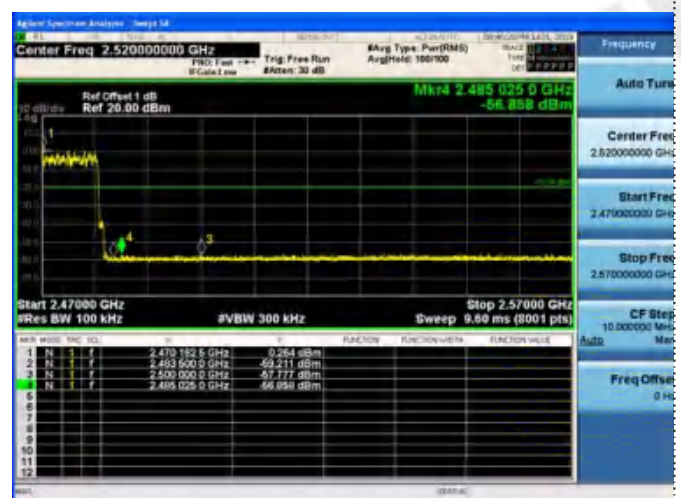
Right Band edge hopping on
