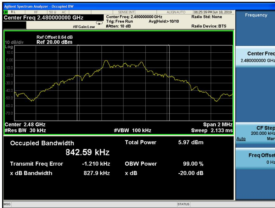
Test Mode:  $\pi/4$ DQPSK
