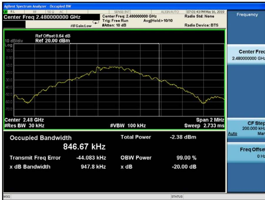
Test Mode:  $\pi/4$ DQPSK
