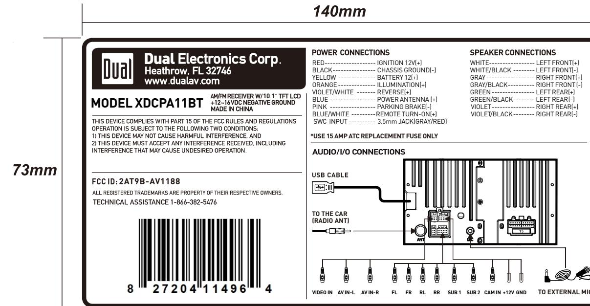
MODEL+UPC LABEL ON THE CHASSIS BODY
