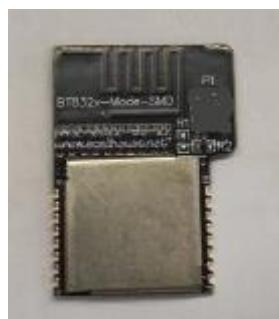
使用 PCB 天线时，模块上 R1 焊接，R2 不焊接。不需要额外器件。
