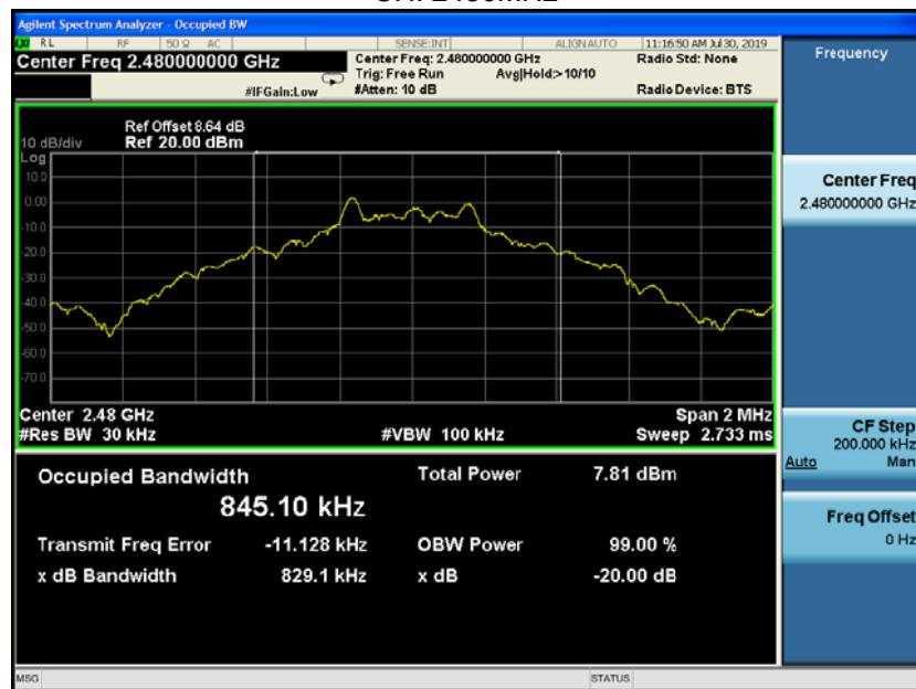
Test Mode:  $\pi/4$ DQPSK
