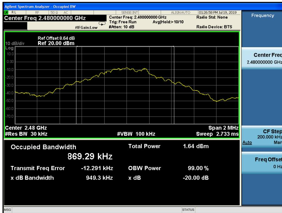
Test Mode:  $\pi$  /4DQPSK
