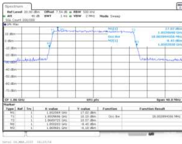
Band2 QPSK BW=20MHz Channel=18700 RB Size=100 Position=#0
