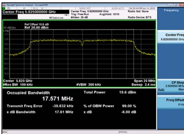
U-NII-3 6dB Bandwidth-802.11n(40MHz) ,5755MHz,Ant0
