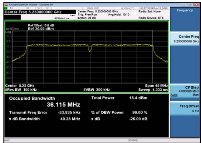
U-NII-1 26dB Bandwidth-802.11ac(80MHz) ,5210MHz,Ant1
