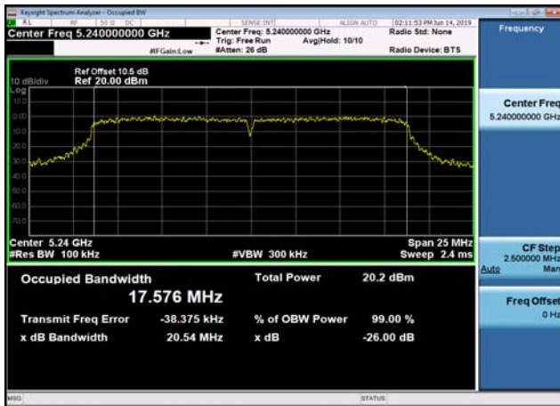
U-NII-1 26dB Bandwidth-802.11ac(40MHz ,5190MHz,Ant0
