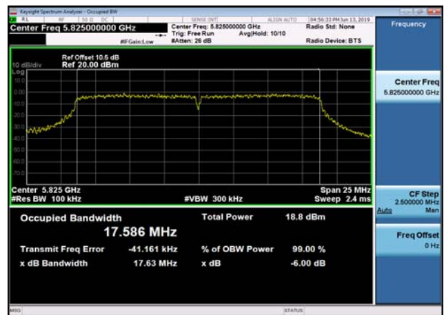
U-NII-3 6dB Bandwidth-802.11n(40MHz) ,5755MHz,Ant1
