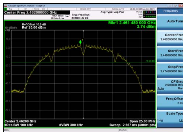
,Plot 1,Reference Level-802.11b ,2462MHz,Ant0
